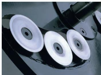
„Disc-Blade“ sistem, budući da fino sječe drvo pod kutom umjesto da lupa po njemu i tako ga reže, je za 1.5dB tiši nego konvencionalni ravnii noževi, prema podacima standardnog testa za ispitivanje buke pri radu sjekača drvene mase. Bitno je napomenuti da se za svako smanjene od 3dB pri emisiji buke, pritisak zvuka na uši smanjuje za čak 50%.
