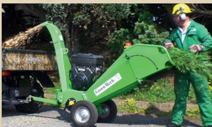
GreenMech CS100 strojevi dostupni su u tri varijante. S vlastitim pogonskim motorom od 16KS ili 18KS, ili kao traktorski priključak s kardanskim pogonom
