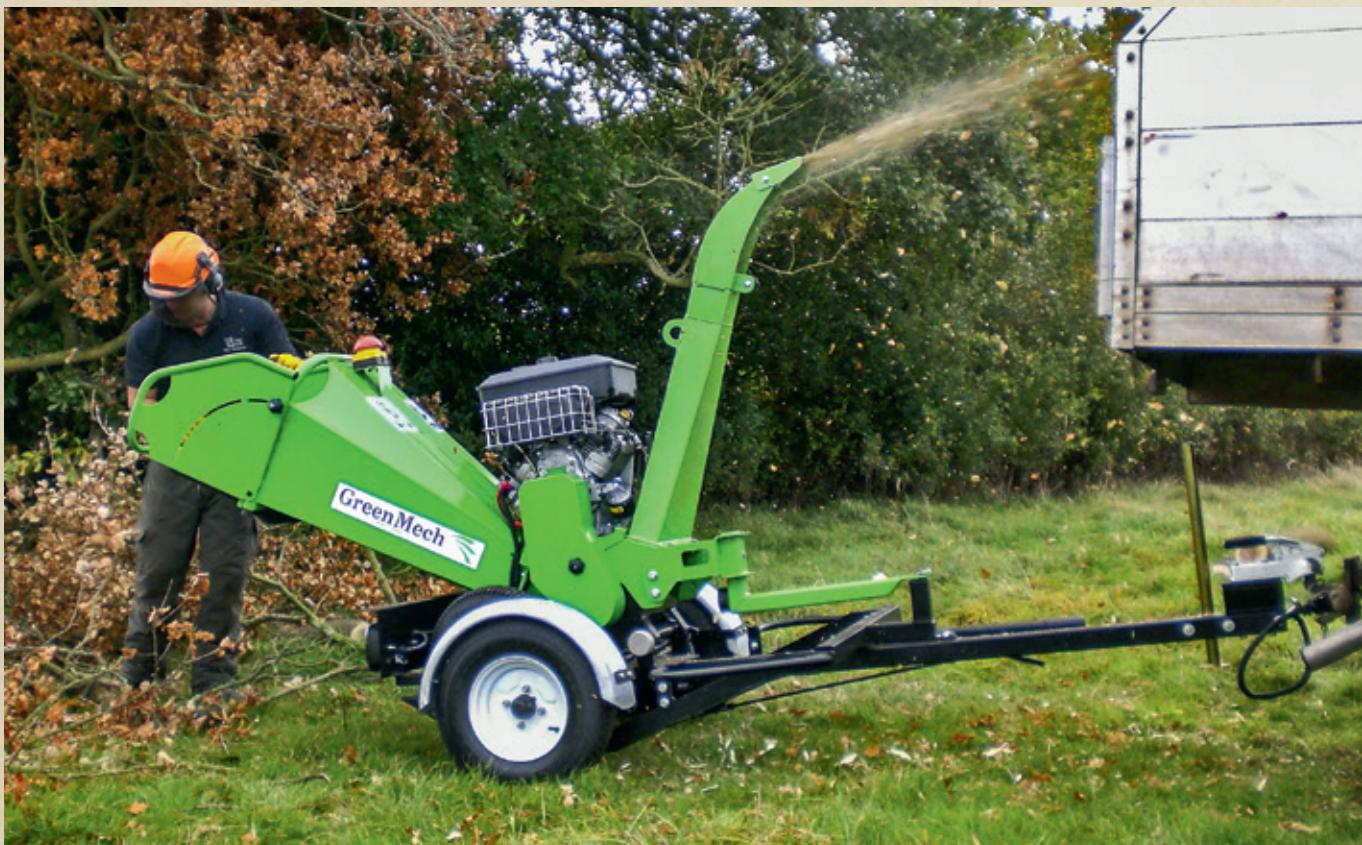
Usmjeravanjem ispušne cijevi sječka se može utočavati u vučno vozilo ili raspršiti po tlu kao malč
