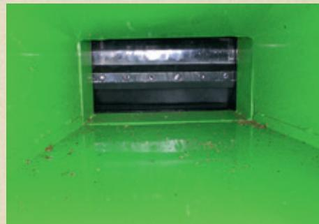
Strojevi serije CS 100 odlikuje jednostavnost rukovanja, visoka sigurnost u radu i velika produktivnost. Dvostruka gumeni zaštitni prelaz sprečava izbacivanje komadića materijala, a veliki utovarni otvor ne zahtjeva usitnjavanje ili obrezivanje materijala
