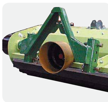
Opcija spajanja s prednje strane na brzi trokut spoj
