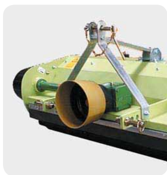
Opcija spajanja s prednje strane na 3-točke spajanja
