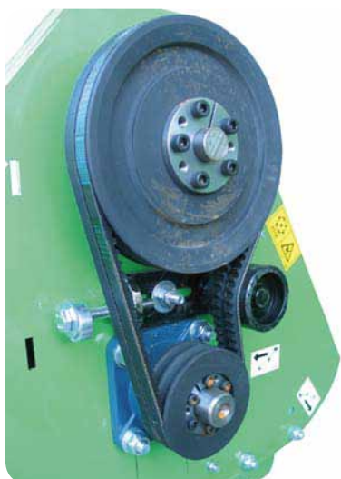
Jednostavno podešavanje i zatezanje remena
