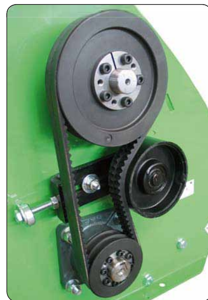
Jednostavno podešavanje i zatezanje remena
