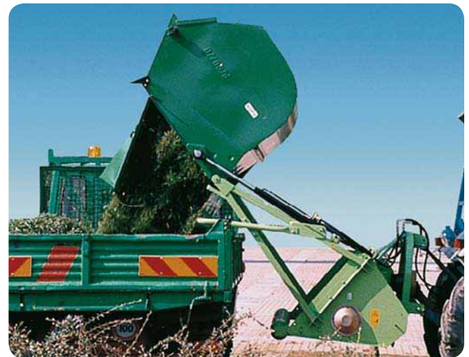
Hidraulično dizanje i istovaranje obrađenog materijala na visini do 2 m.
