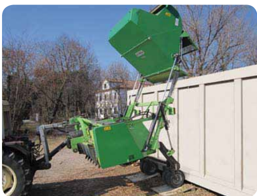
Mogućnost istovara obrađenog materijala na visini do 2,20 m.
