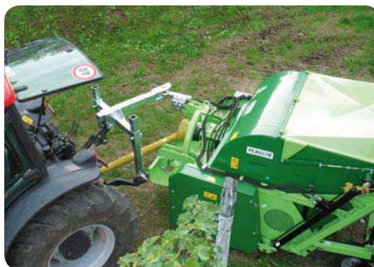
Ruda za vuču omogućuje jednostavnije okretanje na kraju reda. Također, smanjuje težinu stroja koju nosi traktor te je moguća upotreba ovog stroja s manjim traktorom.
