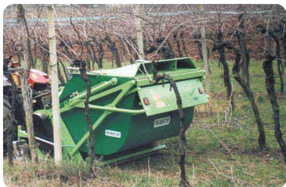
Odlična učinkovitost pri košnji trave i usitnjavanju grana promjera do 5 cm.
