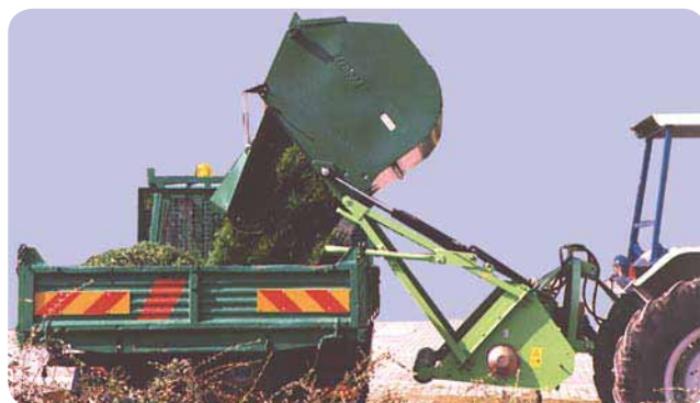
Veliki kapacitet spremnika i mogućnost dizanja i istovara na visini do 2m.
