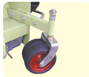
Podešavanje visine rezanja na prednjim okretnim kotačima.
